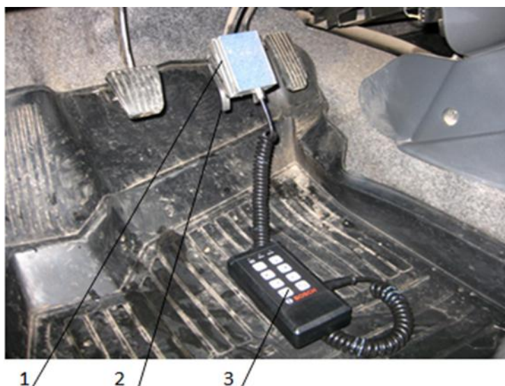
1 – датчик измерения усилия на педали тормоза; 2 – педаль тормоза; 3 – пульт дистанционного управления Рисунок 2 – Беспроводной датчик измерения усилия на педали тормоза с пультом дистанционного управления
