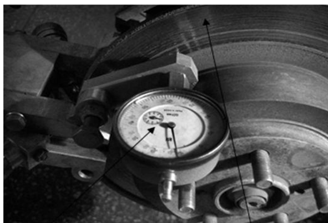
Рисунок 6 – Измерение биения тормозного диска на автомобиле
